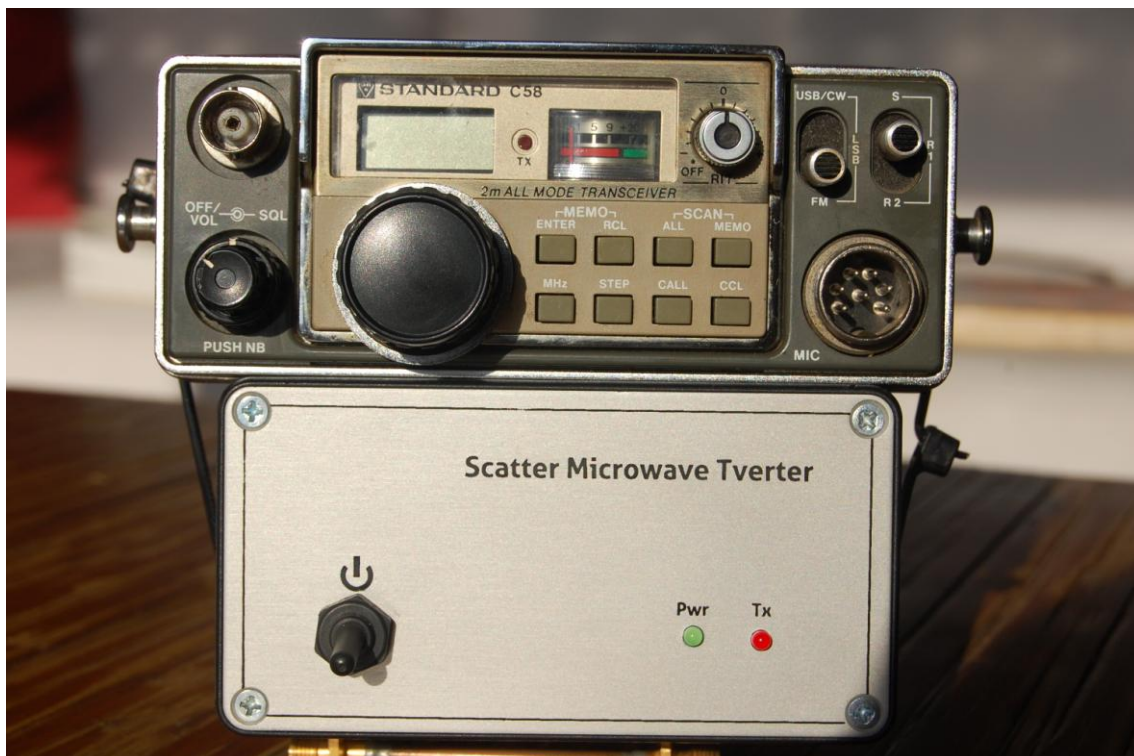
Foto 1: Transverter y radio de VHF
