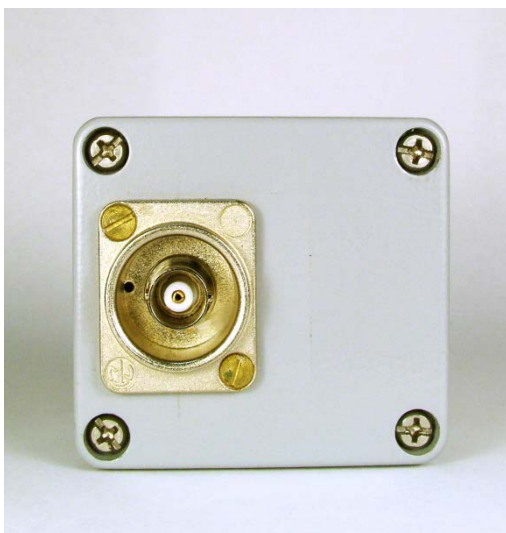
Figura 2.20 Vista desde abajo que muestra el conector BNC empotrado
