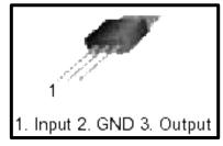
Existen reguladores de esta serie para las siguientes tensiones: 5, 6, 8, 9, 10, 12, 15, 18 y 24 voltios. Se ponen siguiendo las indicaciones anteriores anteriores y ya está, obtenemos una Vout de XX Voltios y sin rizado. Es posible que tengas que montar el regulador sobre un disipador para que disipe bien el calor.
