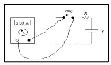
Óhmetros: Sirven para medir resistencias (ohm) y consta básicamente de una caja que aloja todos los componentes, un instrumento con escala digital o analógica calibrada en ohm, un conmutador de rangos de selección, una perilla reguladora de ajuste en cero (en el caso de los analógicos) y dos bornes de conexión con puntas de prueba. Los óhmetros se conectan luego de desconectar la fuente de energía.
