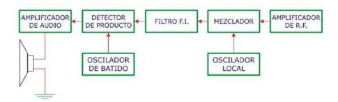
Esquema de un receptor de BLU
