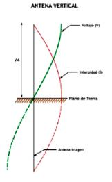
La longitud eléctrica de una onda de radiofrecuencia está relacionada con la velocidad de propagación de las ondas en el espacio y con su frecuencia.
