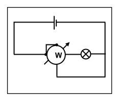
El watímetro o vatímetro es un instrumento que se utiliza para medir la potencia de un transmisor.
