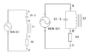
Cuando a la entrada del circuito se le aplica una frecuencia el circuito reaccionará de una forma distinta. La reactancia de un condensador o de una bobina es el valor óhmico que se opone al paso de electrones. Cuando la frecuencia crece la reactancia de la bobina aumenta, en tanto que al del condensador disminuye.
