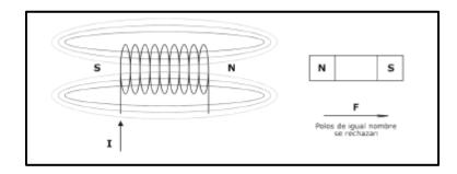
Si hiciéramos circular corriente por el arrollamiento en el sentido indicado y acercáramos un imán a un extremo como indica la figura, veríamos que el imán es repelido con una fuerza F.
