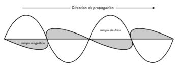
Figura 4.7: La onda senoidal eléctrica se mueve perpendicular a la onda magnética en la dirección de la propagación.
