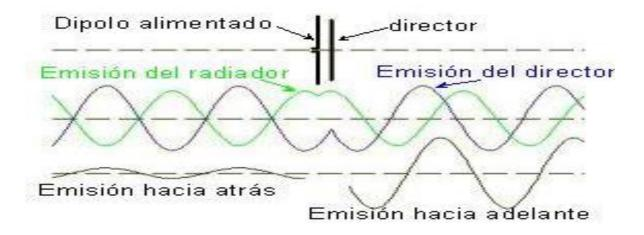
La corriente que circula en el elemento alimentado irradia un campo electromagnético, el cual induce corrientes en los "elementos parásitos" de la antena. Las corrientes inducidas en esos elementos irradian también campos electromagnéticos que a su vez inducen corrientes en los demás. Finalmente la corriente que circula en cada uno de los elementos es el resultado de la interacción entre todos los elementos.
