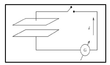
Podemos concluir que el dispositivo formado por las dos placas metálicas (o conductoras) paralelas enfrentadas y separadas por un material dieléctrico, que en este caso es aire, ha sido capaz de retener carga eléctrica (electrones), o dicho de otra manera, es capaz de almacenar energía eléctrica. Tal dispositivo recibe el nombre de CAPACITOR PLANO o simplemente CAPACITOR.
