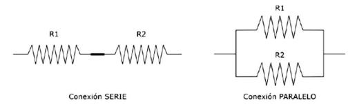
En ambos casos, siempre es posible encontrar un único valor de resistencia que sea equivalente al conjunto de resistencias que forman el circuito. Esa resistencia se llama precisamente **RESISTENCIA EQUIVALENTE.**
