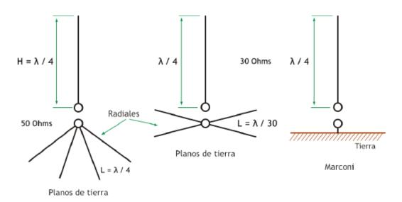
Longitud de una antena vertical de  $\frac{1}{4}$  de longitud de onda = 71,25/frecuencia MHz = 71,25 / 146 = 0,488 m
