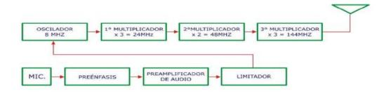
El ancho de banda de una emisión F3E (FM) de banda angosta, habitual en la banda de 2 metros es: 3 KHz.
