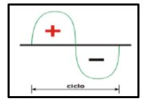
Si se hace pasar una corriente alternada por una bobina de alambre, se forma un campo magnético alrededor de la bobina. Conforme aumenta la corriente (hemiciclo positivo) se expande el campo magnético que cruza transversalmente los conductores de la misma bobina, induciendo en ellos una segunda corriente. Esa corriente tiene una dirección.
