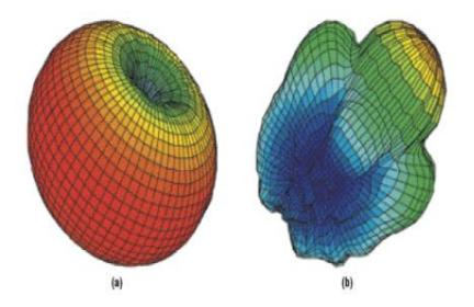
a) Lóbulo de un simple dipolo. b) lóbulo de horno de ganancia estándar (microondas)
