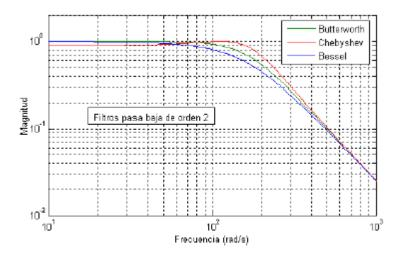
**FILTROS**: Un filtro eléctrico o filtro electrónico es un elemento que discrimina una determinada frecuencia o gama de frecuencias de una señal eléctrica que pasa a través de él, pudiendo modificar tanto su amplitud como su fase.
